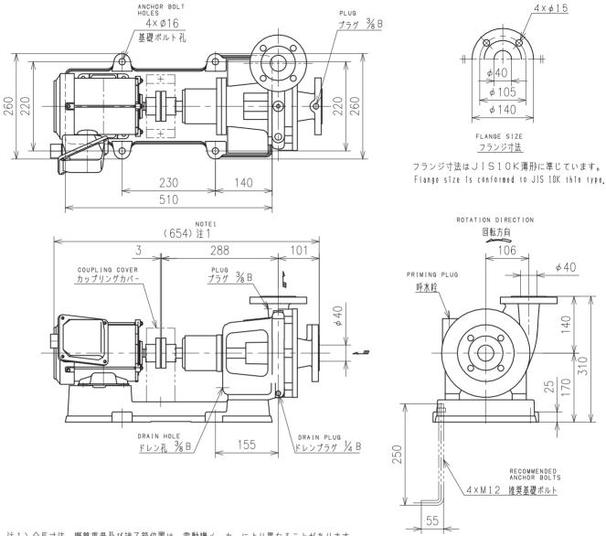
注1) 全長寸法、概算重量及び端子箱位置は、電動機メーカーにより異なることがあります。
