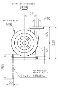
注1)全長寸法、概算重量及び端子箱位置は、電動機メーカーにより異なることがあります。 NOTE1)Total length, mass of the pump and terminal box position has difference depending on motor manufacturer. カップリングカバーは標準付属品です。 Coupling cover is standard accessory.
