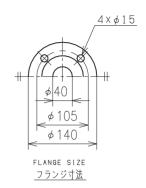
フランジ寸法はJIS10K薄形に準じています。 Flange size is conformed to JIS 10K thin type.
