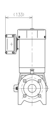
Flange size is conformed to JIS 10K thin type. フランジ寸法はJIS10K薄形に準じています。
