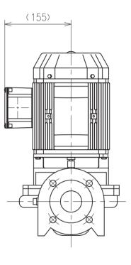
Flange size is conformed to JIS 10K thin type. フランジ寸法はJIS10K薄形に準じています。
