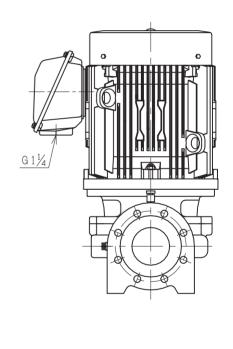
Flange size is conformed to JIS 10K regular type. ※フランジ寸法はJIS10K薄形に準じています。
