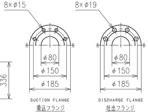
フランジ寸法は吸込側JIS10K薄形、吐出側JIS10K並形に準じています。
