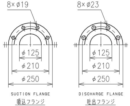
フランジ寸法は吸込側 JIS 10K 薄形、吐出側 JIS 10K 並形に準じています。
