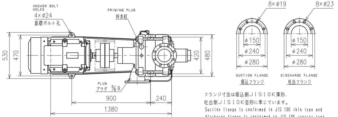
フランジ寸法は吸込側JIS10K薄形、吐出側JIS10K並形に準じています。
