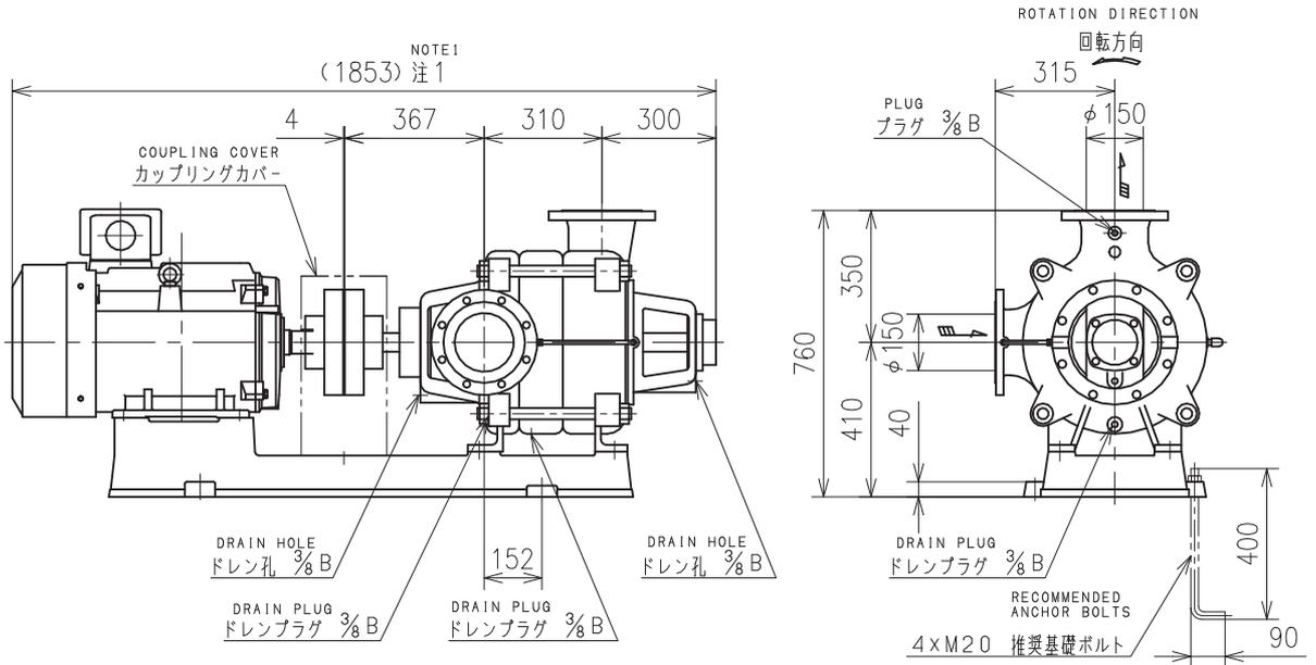
注1) 全長寸法、概算重量及び端子箱位置は、電動機メーカーにより異なることがあります。
