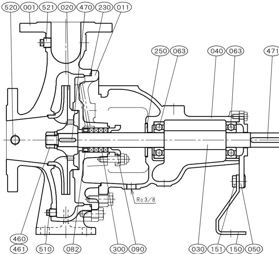
玉軸受は非接触形両シール付きを使用しております。但し玉軸受メーカーにより呼び名称が変わります。
