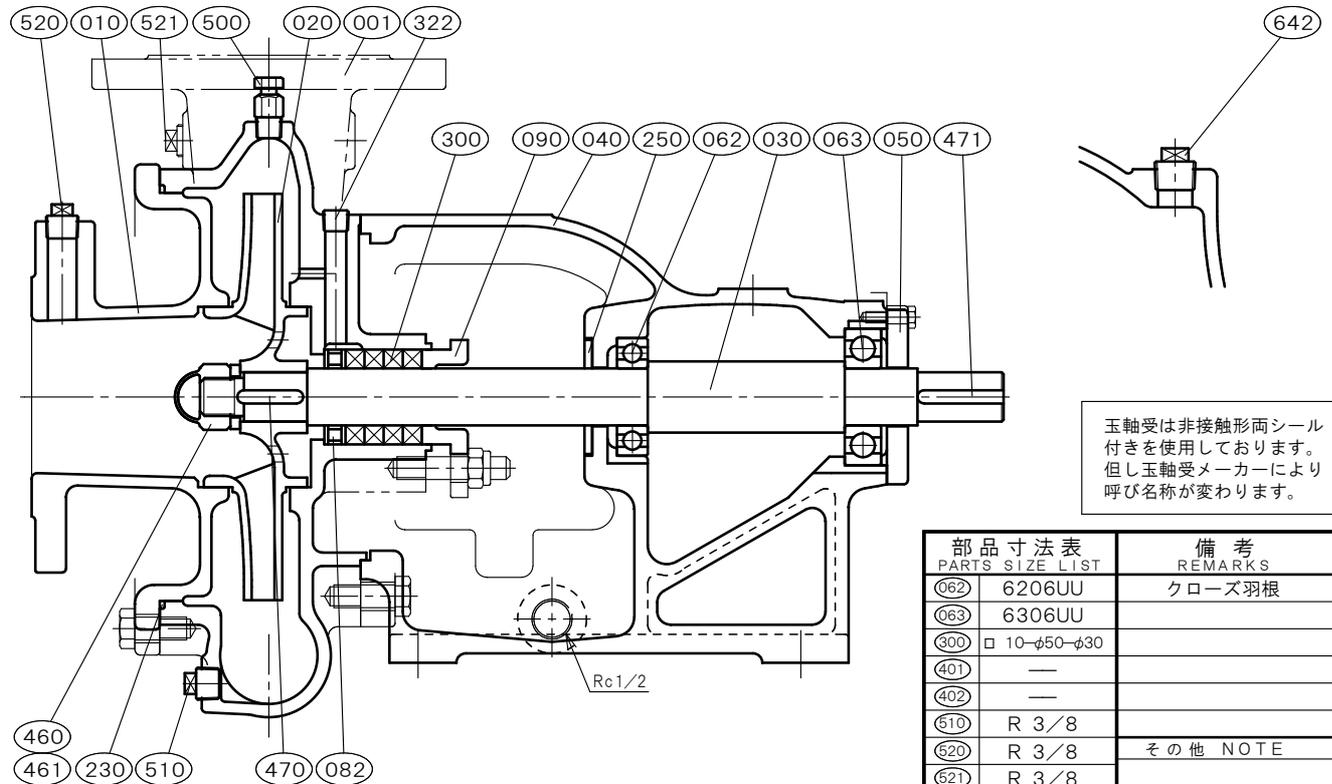
玉軸受は非接触形両シール付きを使用しております。但し玉軸受メーカーにより呼び名称が変わります。
