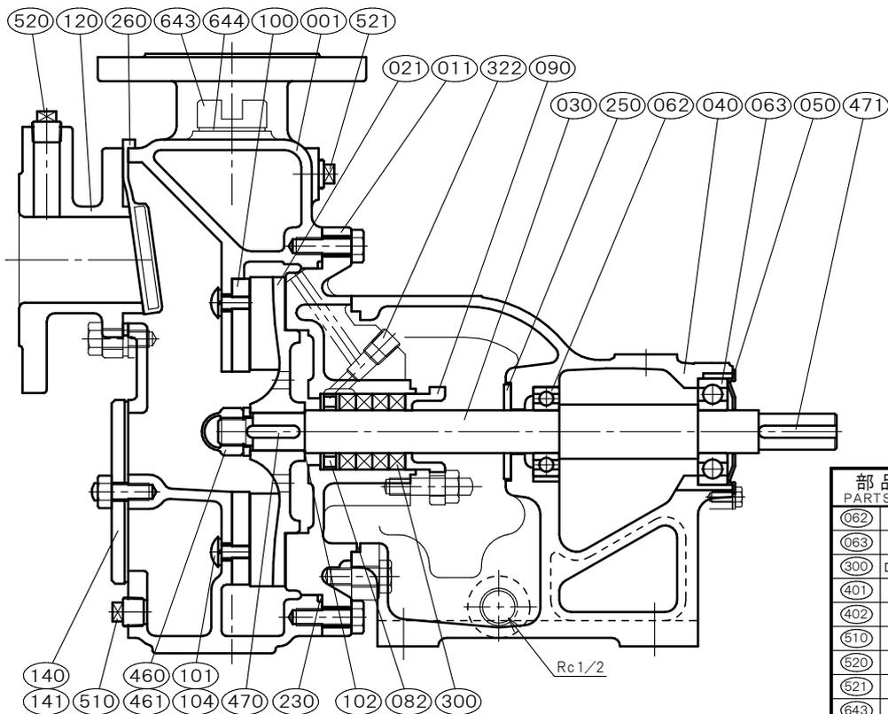
玉軸受は非接触形両シール付きを使用しております。但し玉軸受メーカーにより呼び名称が変わります。
