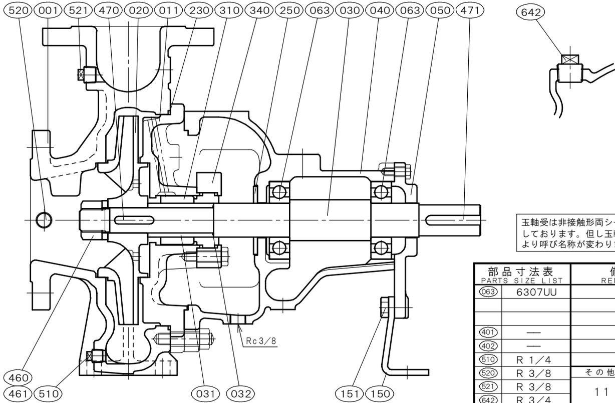
玉軸受は非接触形両シール付きを使用しております。但し玉軸受メーカーにより呼び名称が変わります。
