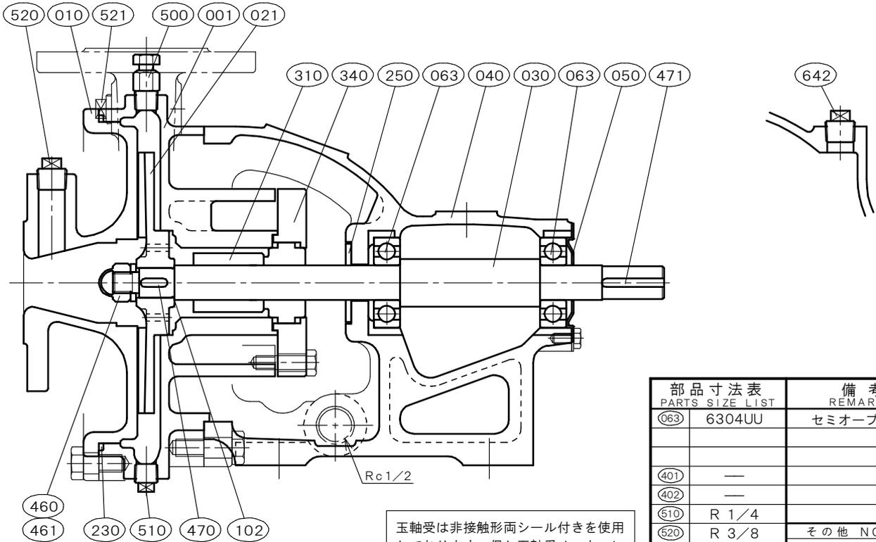
玉軸受は非接触形両シール付きを使用しております。但し玉軸受メーカーにより呼び名称が変わります。
