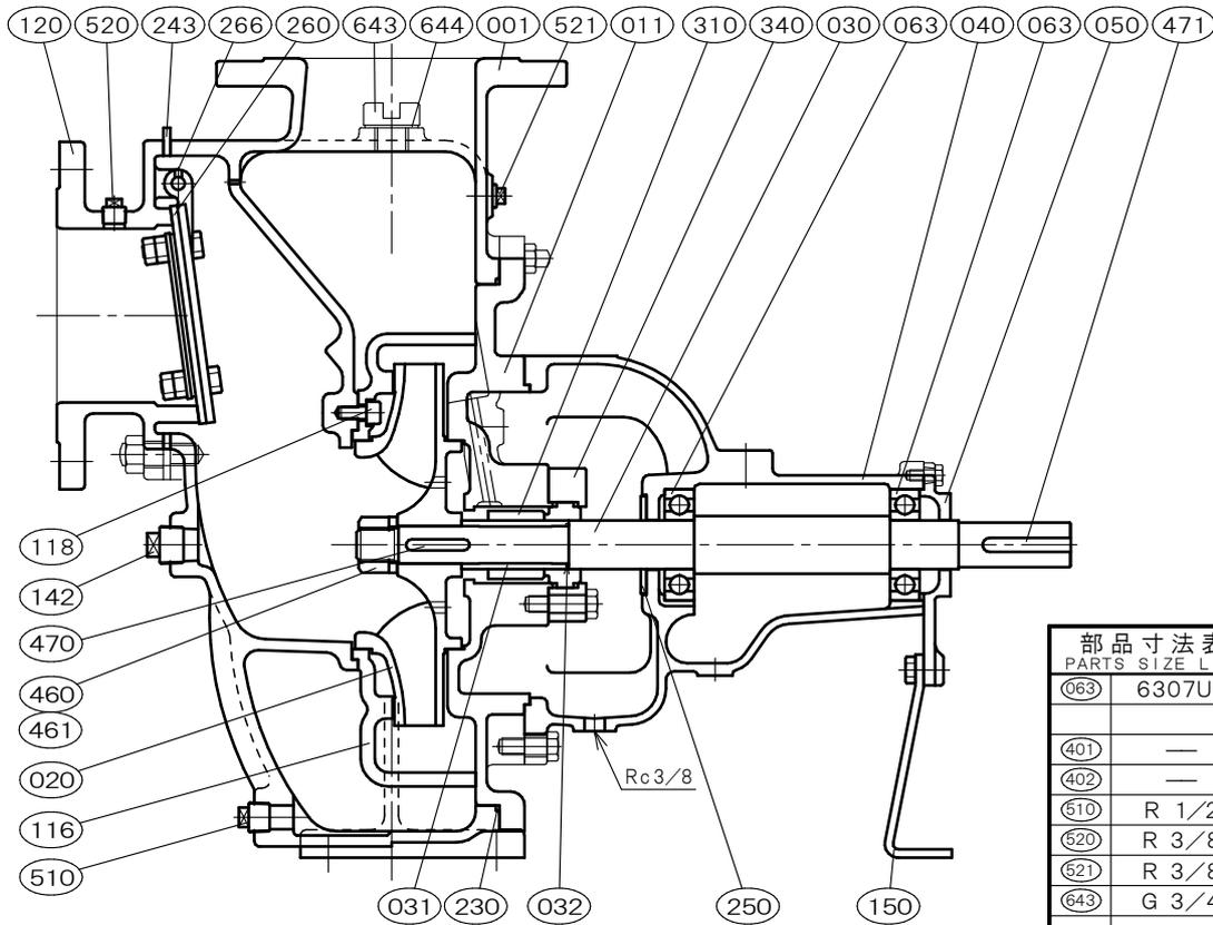
玉軸受は非接触形両シール付きを使用しております。但し玉軸受メーカーにより呼び名称が変わります。
