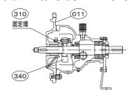
⑤ (011) ケーシングカバーを (040) 軸受から外し、(310) メカニカルシール回転環、(340) メカカバー、(250) 水切りつばの順番に (030) 主軸から抜き取ります。 (スリーブ付の場合は (031) スリーブ及び (032) スリーブパッキンを (030) 主軸から抜き取ってください。)
