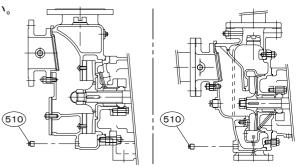
③ 吸込・吐出し配管からポンプを取り外し、(001)ケーシングから(011)ケーシングカバーを取り外します。この状態でポンプ内部は点検できます。摩耗や異常がないかご点検ください。(CO5・COM5等の(001)ケーシング脚部が(600)共通ベッドに取り付けてあるものは(011)ケーシングカバー以後を取り外す事により、配管を外さなくてもポンプ内部を点検する事ができます。)
