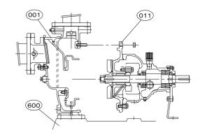
④ (460) 羽根車ナット・(461) 回り止めを取り、(020/021) 羽根車、(102) 調整リングを抜き、(470) 羽根車キーを取ります。※ (020) クローズ羽根車は(102) 調整リングがありません。
