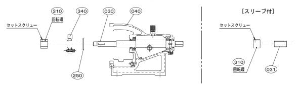
⑥ (050) 軸受カバーを(040) 軸受から外し、(030) 主軸を抜きます。(オイルバス式の場合は予め(422) オイルドレンプラグを外し、中のオイルを抜き取ります。その後(050) 軸受カバー及び(404) オイルパッキンを外します。)
