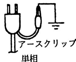
**ガス管、水道管、避雷針、電話線には接地しない！**
