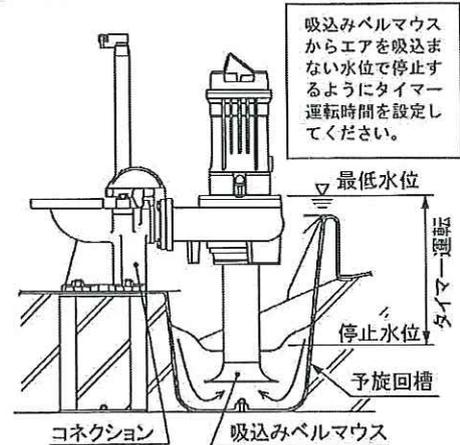
【予旋回槽及びベルマウス付の施工例】
