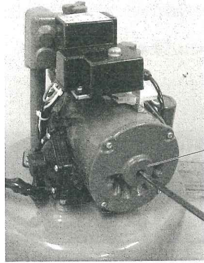
モータシャフト後部に マイナスドライバー用 の溝がついています。
